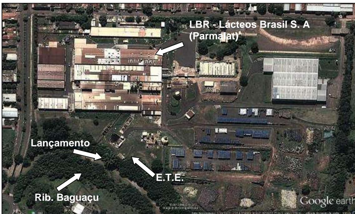
Figura 120. Vista geral da empresa LBR - Lácteos Brasil S. A (Parmalat), com a indicação da E.T.E. e do lançamento de efluentes. (Fonte: Image: 2013 © DigitalGlobe – extraída do Google Earth. Data das imagens 19/2/11)
